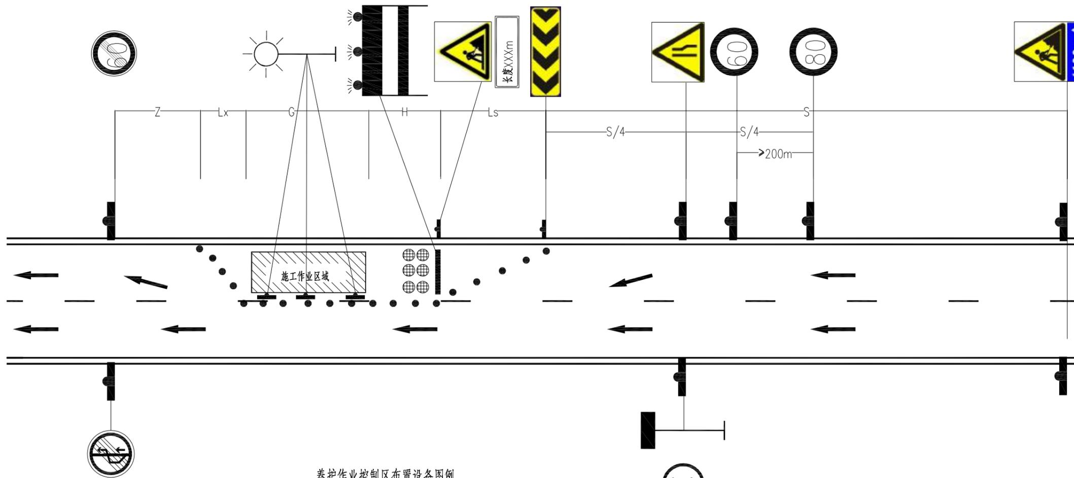
养护作业控制区布置设备图例
