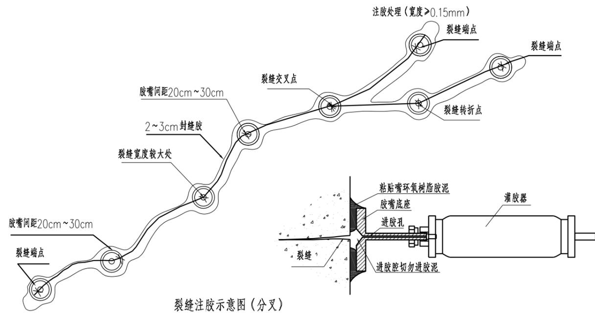
裂缝注胶示意图 (分叉)
