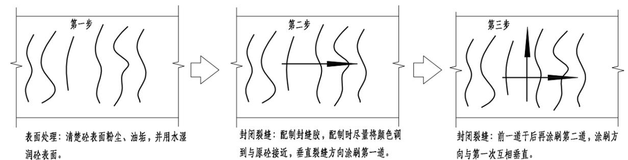
裂缝封闭施工步骤示意图
