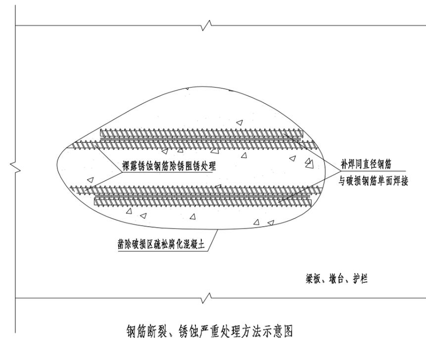
钢筋断裂、锈蚀严重处理方法示意图
